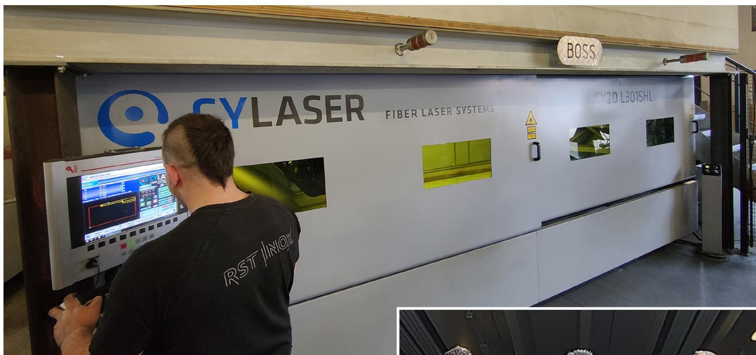
Impianto di taglio laser fibra CY2D HL3015 da 4kW fornito da Cy-laser di Schio
